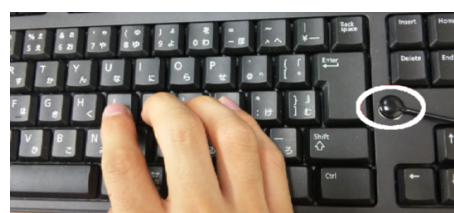
図2: キーボードに装着したピエゾピックアップ
